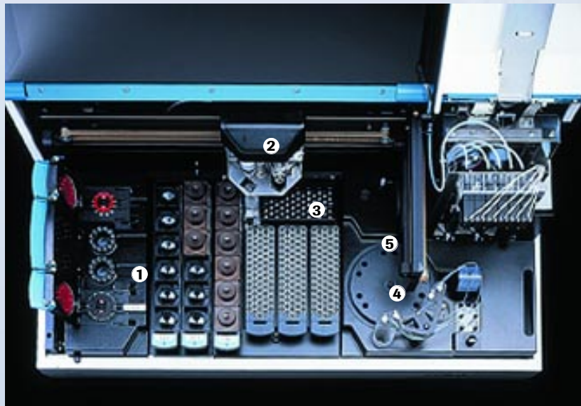
Aparat COBAS AMPLICOR™ łączy pięć instrumentów w jeden zautomatyzowany system.
